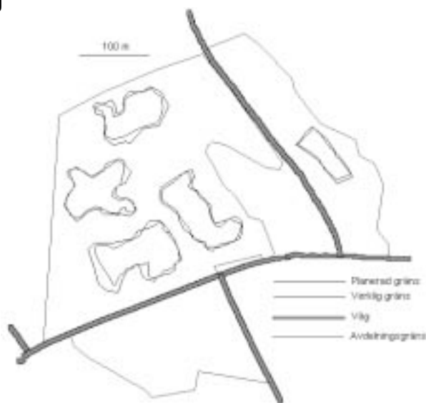
Figur 1. Försöksytor 0,4-1 ha stora där skördaren kört efter gränsmarkering i maskindatorn och markering av fordonet med GPS-utrustning utan tidigare markering i beståndet (Staland, 1999).
