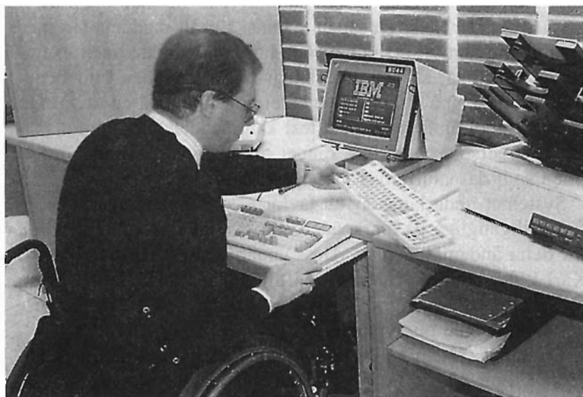
Figur 10. En överläggsplatta med hål för tangenterna – här av typ IBM KeyGuard – kan göra det lättare att undvika att träffa två tangenter samtidigt.
