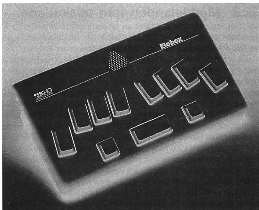
Figur 9. Ett braille-tangentbord, som här ingår i en elektronisk "anteckningsbok" för blinda personer.
