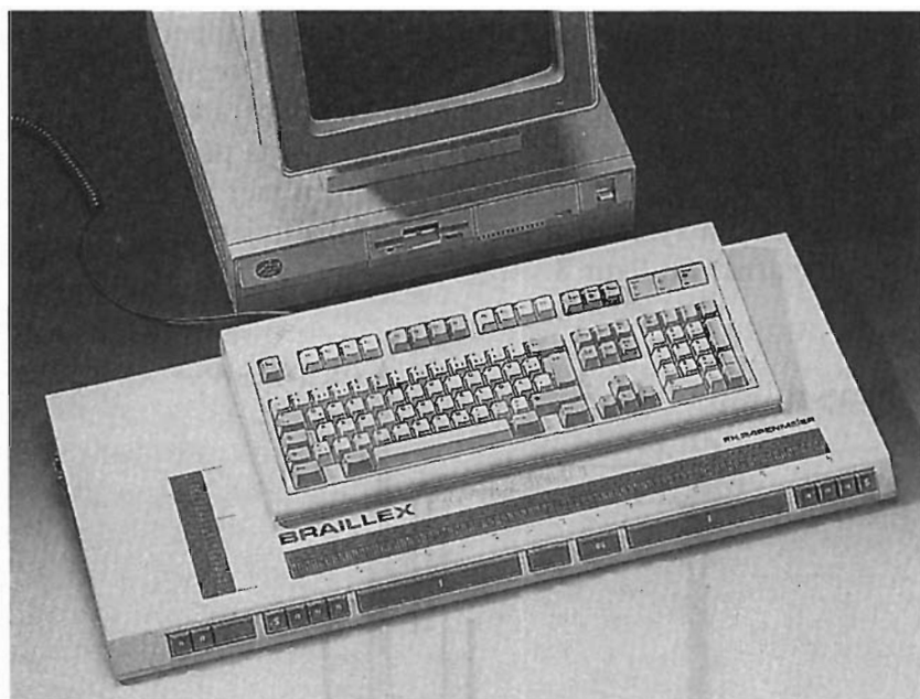
Figur 7. Punktskriftsskena (Braillex-2D), placerad under ett vanligt tangentbord. Kallas med en mild överdrift 2-dimensionell eftersom den ger viss information om flera rader på en gång.
