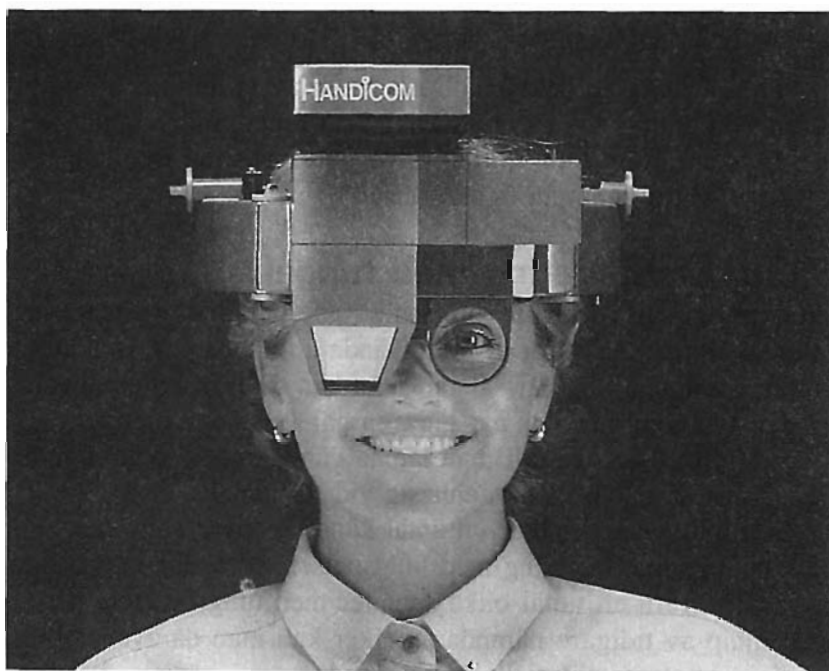
Figur 18. En ögonrörelsekamera, fäst på huvudet.
