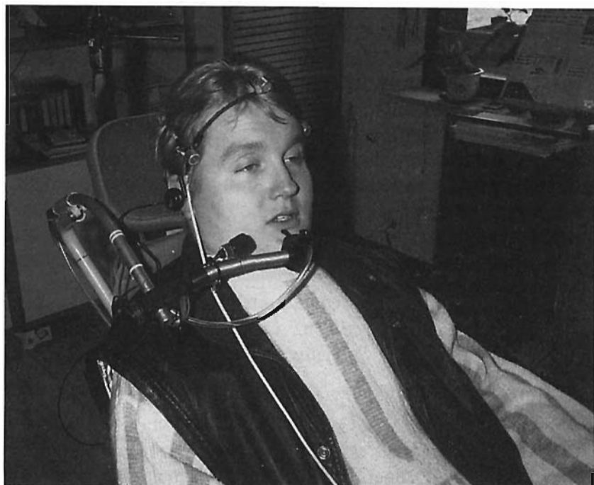
Figur 17. André Alm (AA) i sin rullstol med huvudmusen påsatt (de tre mikrofonerna vid tinningarna och i pannan). (Foto: förf.)
