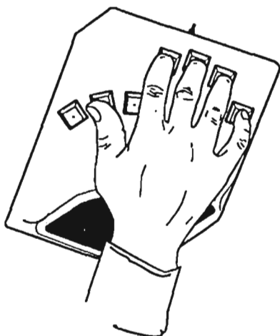
Figur 13. Ett enhandstangentbord (BAT TM ), här för höger hand.
