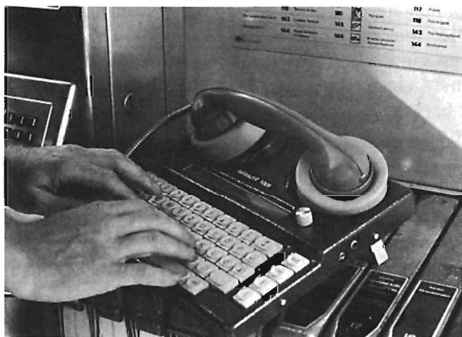
Figur 26. En texttelefon med akustiskt modem och med luren pålagd. Mellan luren och tangentbordet ses en liten textskärm.
