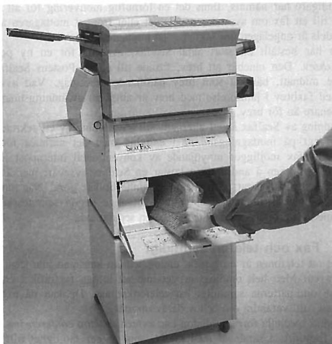
Figur 14. Den övre delen av en Sealfax består av en xerografisk faxapparat. Från denna matas mottagna blad ned till ett låsbart fack, där de kuverteras.
