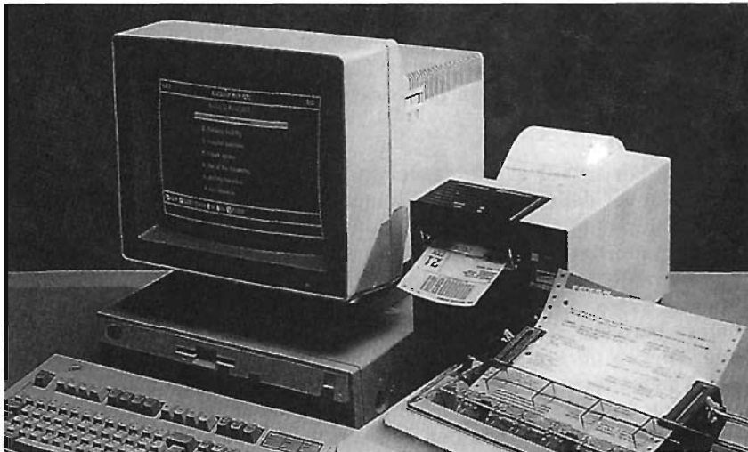
Figur 27 Powership består av en persondator, två skrivare och ett modem.
