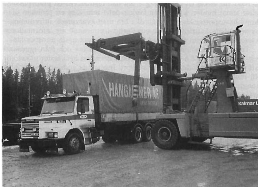
Figur 21 Omlastning av växelflak.
