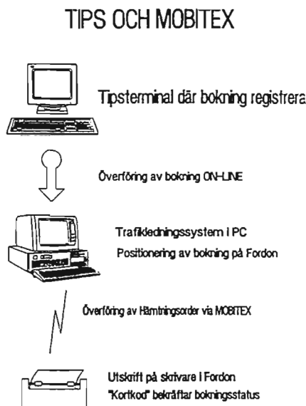
Figur 13 ASG:s transport- och planeringssystem i samverkan med Mobitex.
