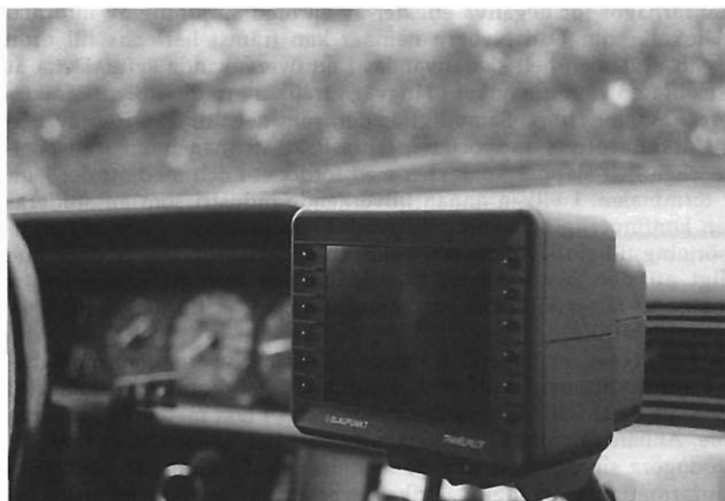
Figur 38 Exempel på en bildskärm i ett fordon vid automatisk fordonsnavigering.
