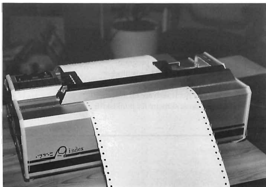
Fig 2. Jan Svenssons skrivare för punktskrift.
