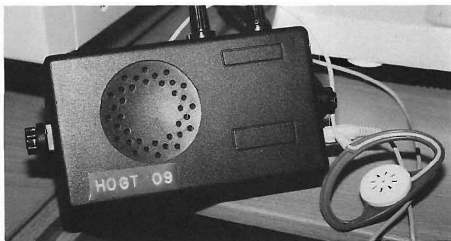
Fig 4. Kontrollbox med högtalare och talsyntes Infovox samt hörsnäcka.
