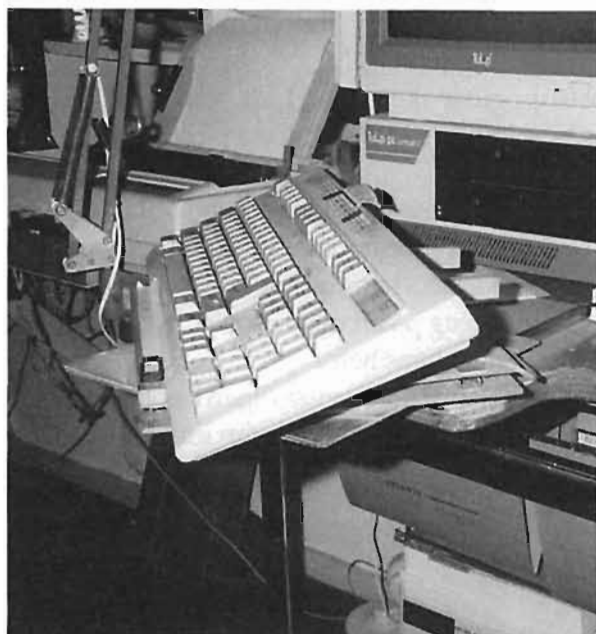
Fig 2. Tangentbordet kan förskjutas och vridas hur som helst i horisontalplanet under det att lutningen är konstant.
