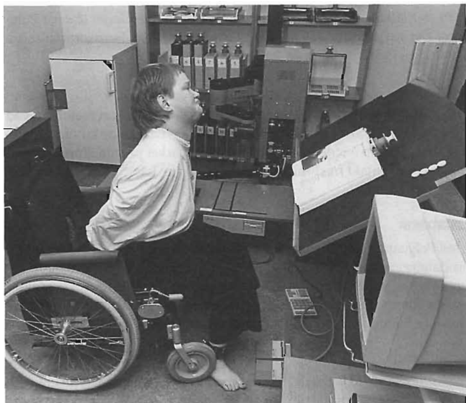
Fig 1. Åse använder sitt justerbara bord som höjs med pedalen. Pärmen har ett grepp som används av roboten för att lyfta pärmen.
