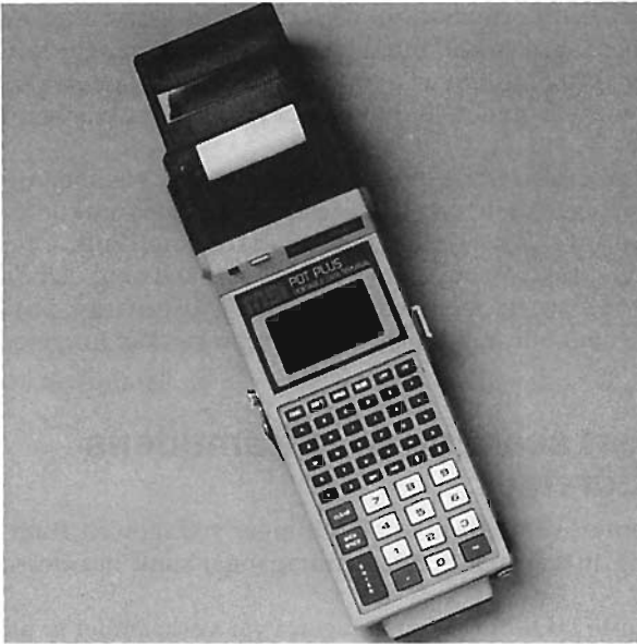
Bild 7 Chaufförens bärbara registreringsutrustning med printer för att kunna märka godset med läsbar streckkod.
