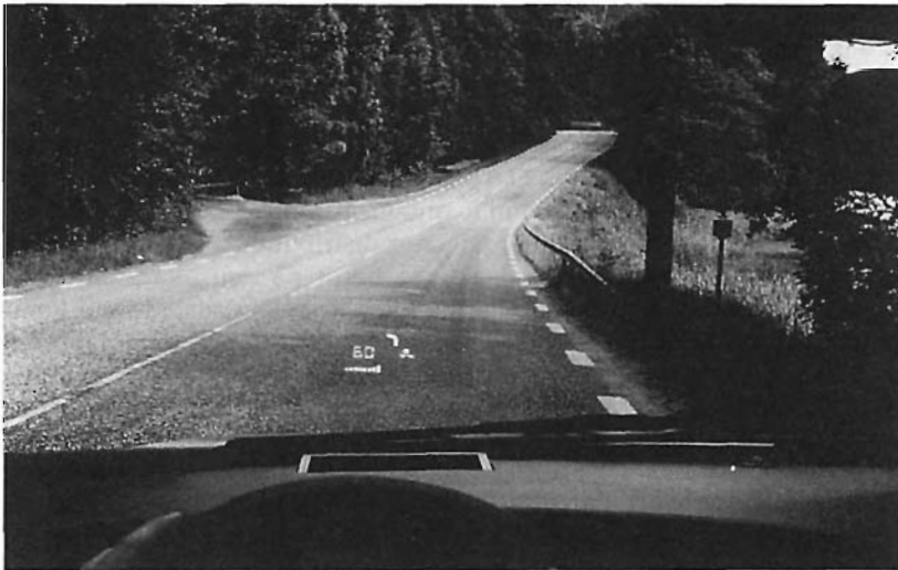
Bild 13 "Head-up-display" i kombination med en ergonomiskt utformad ratt. I ratten finns möjlighet att via tangenter styra informationen som ges på instrumentbrädan och i vindrutan. Källa: Mecel AB.
